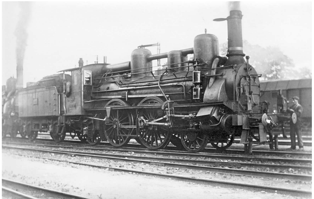
Abbildung 58: kkStB 5.10 nach der Neubekesselung hat den Druckluftbehälter oberhalb des Stehkessels montiert.
